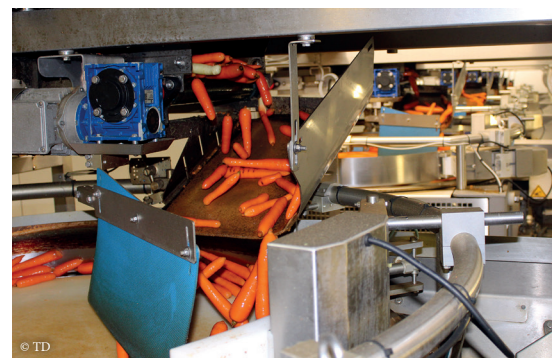
Les carottes arrivent dans les 6 trémies tampons avant d'être dirigées vers les caméras.
