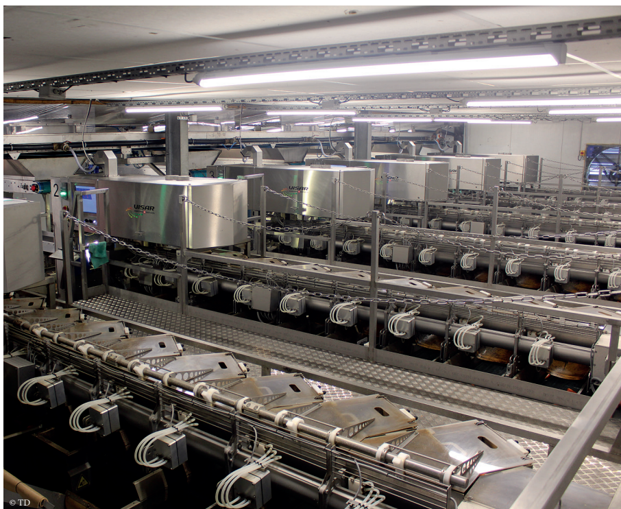
Au sein de l'usine Madrouques, l'installation Visar se compose de six caméras qui affichent un débit de 1,8 m de carottes par seconde.
