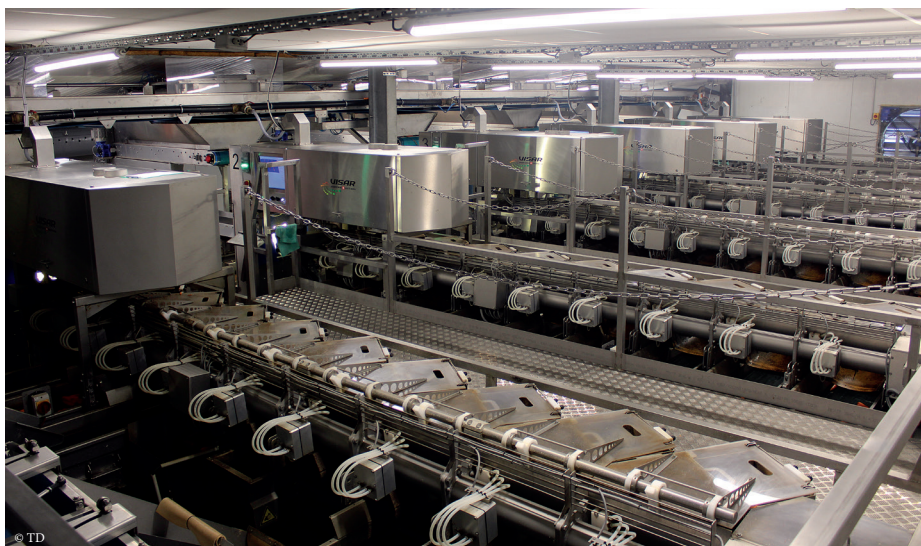
Le trieur optique Visar se compose ici de 6 caméras.
