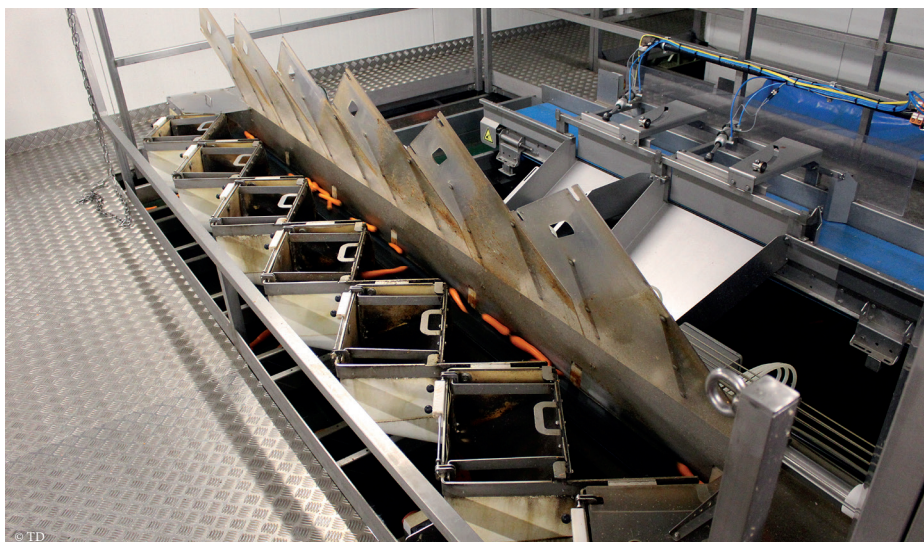
Un système d'éjection de ligne permet de répartir les carottes sur 9 tapis selon leur qualité.
