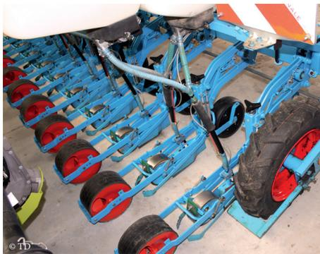
L'élément semeur MS de Monosem permet de placer les graines en bande à 1 cm de profondeur et de les rappuyer correctement.
