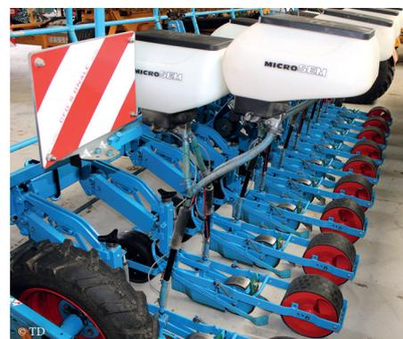
Le semoir Monosem de l'exploitant ne comporte plus de distribution. Ce sont les micro-granulateurs qui assurent la bonne quantité de graines.
